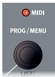
Das Piano 3 bietet die vier Programm-Bänke A, B, C und D. Jede Bank umfasst fünfzig Programme, sodass insgesamt zweihundert Speicherplätze zur Verfügung stehen. In den Bänken sind die Programme entsprechend den fünf Programmtasten im oberen Bereich der Program-Sektion zu Fünfergruppen zusammengefasst. Die Navigation durch und die Auswahl von Programmen erfolgt mit dem **PROG**-Endlosregler oder direkt über die fünf Programmtasten.
