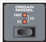
三个风琴的设置是通过拉杆实现的。在一个开关模式中使用farfisa，此时只有两个设置(开启或关闭)。
