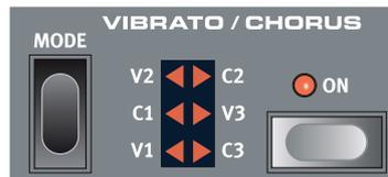
**B3**-音轮风琴原型的颤音和和弦扫描仪由一个延时线和旋转扫描仪组成。要获得颤音效果，需要激活信号相移。要获得和弦效果，相位调制信号被添加到原始信号中。三种不同类型的和弦(C1 - C3)和三种不同类型的颤音(V1-V3)都是可用的。
