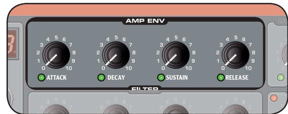
Mit der Amplifier Envelope steuern Sie, wie sich die Amplitude des Sounds im Verlauf ändert. Durch eine Modulation des Amplifiers mit einer Hüllkurve können Sie dem Klang seinen grundlegenden „Lautstärkeverlauf“ geben. In der Praxis ist dieser Lautstärkeverlauf einer der wichtigsten Aspekte zur Identifizierung eines Klangs. Über die Amplifier-Hüllkurve können Sie einen Sound „weicher“, „härter“, „angeschlagen“, „statischer“ etc. gestalten.
