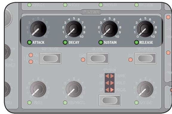
Die Filter Envelope dient zur Modulation und Steuerung des Filter Frequency Cutoffs in dem Zeitbereich, wenn eine Taste gedrückt und dann wieder losgelassen wird.
