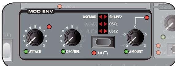
Die Modulation Envelope ist eine Hüllkurve mit Regler für Attack, Decay/Release und Amount. Sie gibt ein Steuersignal aus, das zur Modulation verschiedener Ziele im Nord Wave genutzt werden kann. Die Modulation der Hüllkurve kann wahlweise positiv oder negativ verlaufen, zur Steuerung dient der *MOD ENV AMOUNT*-Regler.
