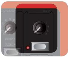
Der *TUBE AMP*-Effekt fügt dem Sound eine röhren-typische Verzerrung hinzu.
