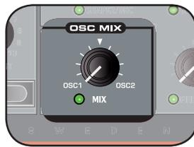
Bei der Einstellung *OSC1* oder *OSC2* ist nur der entsprechende Oszillator hörbar. Bereich: 1:100% bis 2:100%
