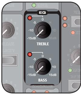
2-Band-Equalizer mit einer Shelving-Charakteristik, der zum Boosten oder Absenken von Frequenzen im Sound benutzt werden kann. Bereich: von -15dB bis +15dB
