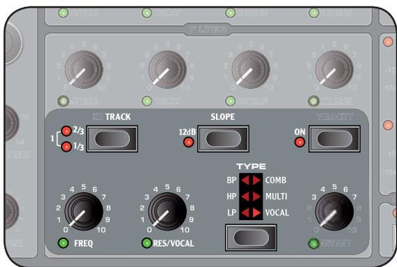
Der Filter ist eine der wichtigsten Komponenten bei der Gestaltung des Gesamt-Timbres eines Sounds. Der harmonische Inhalt, den die Oszillatoren erzeugen, kann mit dem Filter geformt und der Filter selbst kann dabei mit verschiedenen Funktionen moduliert werden. Der Nord Wave bietet eine Auswahl an klassischen Synthesizer-Filtern sowie verschiedene Multi-Mode-Filter.
