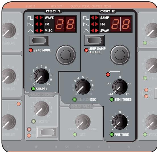
Der Oszillator ist die eigentliche Grundlage der Klangerzeugung in einem Synthesizer: Er erzeugt die Wellenform mit harmonischem Inhalt. Diese wichtige Klangeigenschaft kann im weiteren Verlauf des Signalpfads geformt und/oder moduliert werden.
