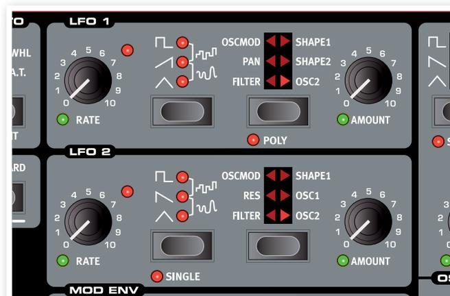
L'**LFO** è un Low Frequency Oscillator, cioè un oscillatore che produce forme d'onda come un normale oscillatore, ma con alcune differenze:
