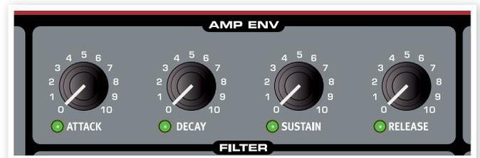
Amplifier Envelope viene usato per controllare come l'ampiezza del suono deve cambiare nel tempo. Modulando l'amplificatore con un involuppo, si può dare al suono la sua "forma" di base. Infatti, la "forma del volume" è uno dei più importanti fattori per identificare il suono. Impostando l'involuppo dell'amplificatore in modo appropriato si può creare un suono "morbido", "duro", "pizzicato", "statico" ecc.
