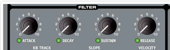
Il Filter Envelope viene usato per modulare o controllare il Cutoff di Filter Frequency nell'arco di tempo da quando un tasto viene tenuto premuto a quando viene rilasciato.
