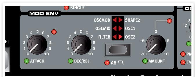
Il Modulation Envelope è un involuppo con Attack, Decay/Release e controlli Amount. Mandando un segnale di controllo da usare per modulare varie destinazioni del Nord Wave. La modulazione dall'involuppo può essere sia positiva che negativa, e questo è determinato dalla manopola **Mod Env Amount**.
