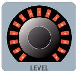
**LEVEL**-Regler sind von einem LED-Ring umgeben. An diesem Ring lässt sich der aktuelle Wert des zugeordneten Lautstärkeparameters ablesen.
