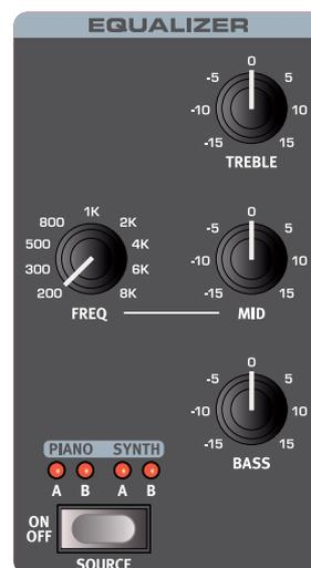
ⓘ *Das Equalizer-Modul kann so eingestellt werden, dass es allen Layern zugeordnet sind: In diesem Fall leuchten alle Source-LEDs.*
