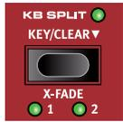
Drücken Sie **KEY**, um den Split-Punkt schrittweise zwischen den 7 Split-Punkten C3 bis C6 zu verschieben, bis die gewünschte Position erreicht ist. Die LEDs oberhalb der Klaviatur zeigen die aktive Split-Position an.
