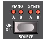
**ON/OFF**-Tasten dienen zum Aktivieren einer Funktion oder einer Gruppe von Funktionen (z. B. Effekte) und zeigen ihren On/Off-Status und bei den meisten Effekten auch die Zuordnung zu einem Piano- oder Sample-Synth-Layer über eine oder mehrere LEDs an.
