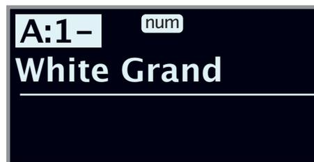
*In diesem Beispiel wurde die Taste Program Select 1 gedrückt. Der Bindestrich (-) im Display weist darauf hin, dass eine weitere Zahl eingegeben werden kann, um beispielsweise Programm 11-15 auszuwählen.*
