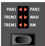
Mit den *Auswahl*tasten wird eine Einstellung unter mehreren Optionen ausgewählt. Die aktuelle Auswahl wird dabei mit Hilfe von runden bzw. dreieckigen LEDs dargestellt. Durch mehrfaches Drücken der Taste wechselt man zyklisch durch alle verfügbaren Optionen.
