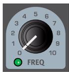
Über den steuerbaren Regler für die Filterfrequenz **FREQ** wird der Punkt für die *Cut-Off Frequency* im Spektrum festgelegt – ab diesem Wert setzt das Filter ein. Das Ergebnis dieser Bearbeitung hängt vom Typ des gewählten Filters ab.
