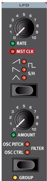
Der Niederfrequenzoszillator (**LFO**) erzeugt eine Wellenform, die zur zyklischen Modulation des gewählten Zielparameters genutzt werden kann: der Tonhöhe des Oszillators (**OSC PITCH**), des Parameters zur Oszillatorsteuerung (**OSC CTRL**) oder der Filterfrequenz (**FILTER**).
