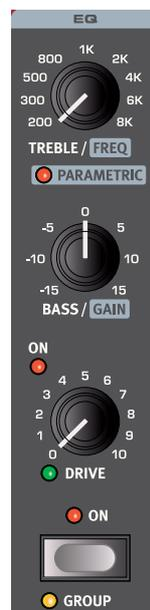
Der Nord Wave bietet zwei Betriebsarten für den **EQ**: einen Modus mit zwei festen Bändern mit Reglern für **BASS** und **TREBLE** sowie einen 1-bandigen **PARAMETRIC**-Modus, der aktiviert wird, indem Sie den Treble-Regler bei gedrückter Shift-Taste voll aufdrehen.
