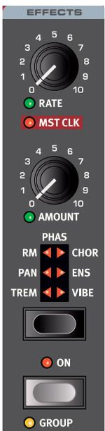
Die **EFFECTS**-Einheit integriert sechs unterschiedliche Modulationseffekte. Mit der zugehörigen Auswahltaste schalten Sie zwischen den verfügbaren Einstellungen um.
