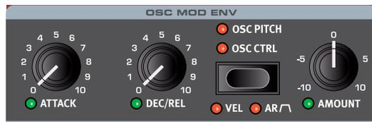
Die Parameter **PITCH** (in Halbtönen) oder **OSC CTRL** für den Oszillator (weitere Informationen weiter unten) können über die dedizierte Modulationshüllkurve des Oszillators moduliert werden.
