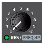
Mit dem Resonanz-Parameter (**RES**) kann die Filtercharakteristik zusätzlich beeinflusst werden. Wenn Sie die Resonanz anheben, werden die Frequenzen um die Filtereinsatzfrequenz verstärkt, wodurch der Sound dünner klingt.
