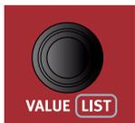
Die *Endlosregler* im Nord Wave 2 sind Drehregler ohne Anfangs- oder Endpunkt und dienen dazu, Parameter und Einstellungen schrittweise einzustellen. Der **VALUE**-Endlosregler ist ein Beispiel dafür. In diesem Handbuch werden Endlosregler manchmal auch als *Encoder* bezeichnet.
