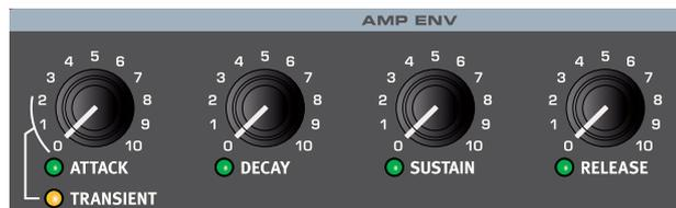
Die Lautstärkehüllkurve (**AMP ENV**) dient der Kontrolle des *Lautstärkeverlaufs* über die Zeit. Durch eine Modulation des Verstärkers mit einer Hüllkurve können Sie dem Klang ein Grundprofil und einen sich entwickelnden Charakter verleihen. In der Praxis ist dieser Lautstärkeverlauf einer der wichtigsten Aspekte zur Identifizierung eines Klangs. Durch Auswahl einer geeigneten Lautstärkehüllkurve lassen Sie einen Sound „weich“, „hart“, „gezupft“, „statisch“ etc. klingen.
