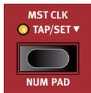
Die Masterclock im Nord Wave 2 ermöglicht die Synchronisation für Arpeggiator/Gate, LFO sowie die Delay- und Effektzeiten im Nord Wave 2. Dabei können die Funktionen nicht nur zueinander synchronisiert werden, sondern Sie können für besondere rhythmische Effekte auch verschiedene Unterteilungen für die einzelnen synchronisierten Komponenten einrichten.
