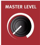
Der Regler **MASTER LEVEL** steuert die Gesamtlautstärke an den Audioausgängen für die Line-Ausgänge und den Kopfhörerausgang. Die physikalische Position des Reglers zeigt den aktuellen Ausgangspegel, der nicht mit dem Programm gespeichert wird.
