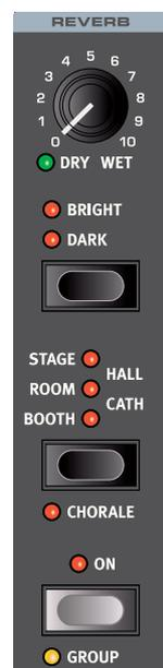
Die **REVERB**-Einheit simuliert die natürlichen Reflexionen in unterschiedlichen akustischen Umgebungen. Es stehen fünf Reverb-Typen mit verschiedener Länge und Dichte zur Verfügung, die über die LEDs oberhalb der Wahl-taste angezeigt werden.
