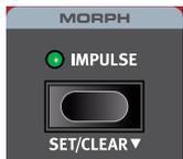
Die Funktion **IMPULSE MORPH** ermöglicht Ihnen, einen oder mehrere Parameter mit einem einzigen Tastendruck zu verändern und so subtile oder drastische Klangwechsel umzusetzen. Abseits aller Parameter, die als Ziele für die oben beschriebenen kontinuierlichen Morphs bereitstehen, kann Impulse Morph etliche Tasten für Parameteränderungen steuern, wie etwa den Filtertyp oder den Status der Arpeggiator/Gate-Sektion.
