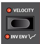
Wenn **VELOCITY** eingeschaltet ist, wird der Grad der Modulation durch die Filter Envelope in Abhängigkeit zur Anschlagsstärke der gespielten Noten gebracht.
