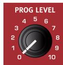
Der Regler **PROGRAM LEVEL** bestimmt den Ausgabepegel für ein Programm. Er wird im Unterschied zum Regler Master Level mit dem Programm gespeichert. Mit diesem Regler gleichen Sie die Lautstärken zwischen Programmen ohne die vier Fader für die Layer an.
